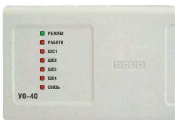
«УО-4С исп.02» предназначено для использования в автономном режиме или в составе ИСО «Орион» для контроля охранных и пожарных неадресных извещателей, контакторов и сигнализаторов с нормально-замкнутыми или нормально-разомкнутыми контактами и передачи извещений по каналам сотовой связи GSM на ПЧН или сотовый телефон пользователя.
