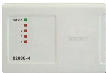
Предназначен для использования в автономном режиме или в составе ИСО «Орион» для контроля различных типов охранных и пожарных неадресных извещателей, контакторов и сигнализаторов с нормально-замкнутыми или нормально-разомкнутыми контактами и релейного управления внешними исполнительными устройствами.
