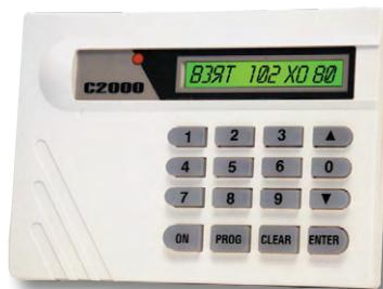
Пульт «C2000» предназначен для информационного объединения приборов ИСО «Орион» с целью организации единого центра управления и сбора системных сообщений, объединения шлейфов сигнализации в разделы, создания перекрестных связей между разделами и выходами разных приборов, расширения возможностей отображения информации.
