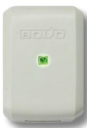
Предназначен для преобразования сигналов интерфейса RS-232 в сигналы последовательного интерфейса с уровнями 5В TTL/CMOS. В ИСО «Орион» используется для подключения радио-передатчика ATS100 радиосистемы передачи извещений LARS или радиопередатчика TRX-150 радиосистемы «Орион Радио» к пульту «С2000М» с целью радиомониторинга охраняемых объектов
