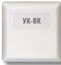
Устройство содержит два реле с переключающими контактами и схему управления, позволяющую включать реле сигналом уровня логическая «1» (+5В КМОП).
