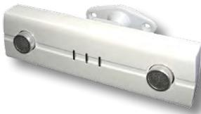
Извещатель охранный объемный ультразвуковой предназначен для обнаружения движения нарушителя в охраняемой зоне и выдачи извещения о тревоге на пульт централизованного наблюдения (ПЧН), систему передачи извещений (СПИ) или прибор приемно-контрольный (ППК) изменением состояния шлейфа сигнализации (ШС) реакцией оптореле
